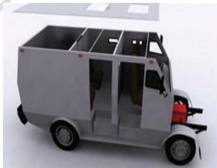
En la zona de la mampara central, que delimita el compartimento donde viajan los guardias de seguridad con el área de almacenamiento, se instalará un sistema o mecanismo que permita la introducción de objetos e impida su sustracción, dotándole de un blindaje que sólo se podrá abrir en la base de la Empresa de Seguridad.
